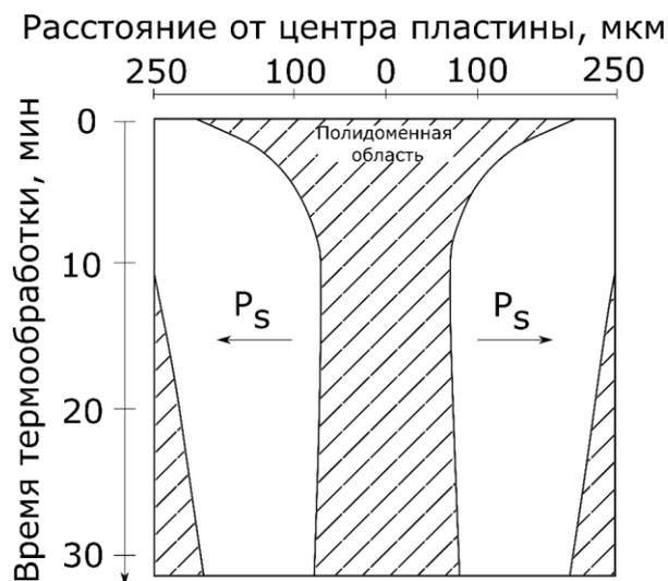
Рисунок 38 – Зависимость доменной структуры в протонзамещенном кристалле LT Z-среза от времени выдержки при температуре выше точки Кюри ( $640\text{ }^{\circ}\text{C}$ ) [418]
