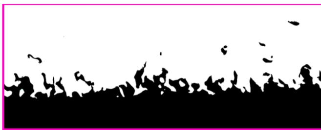
Рисунок 55 – Доменная структура кристалла LN Z-среза, отожженного в течение 2 часов в контакте с сапфировой подложкой
