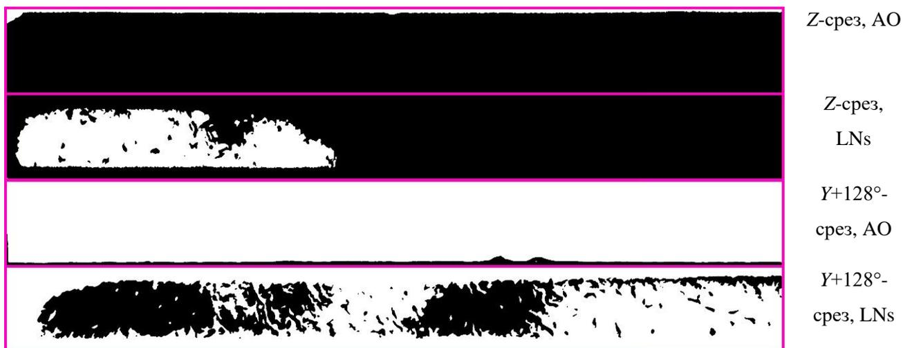
Рисунок 57 – Доменная структура, сформировавшаяся в кристаллах при нулевой выдержке на температуре 1150 °С и двухсторонним нанесением порошков; монодоменному состоянию исходной пластины соответствует полностью черный цвет в случае кристаллов Z-среза и полностью белый цвет в случае кристаллов Y+128°-среза
