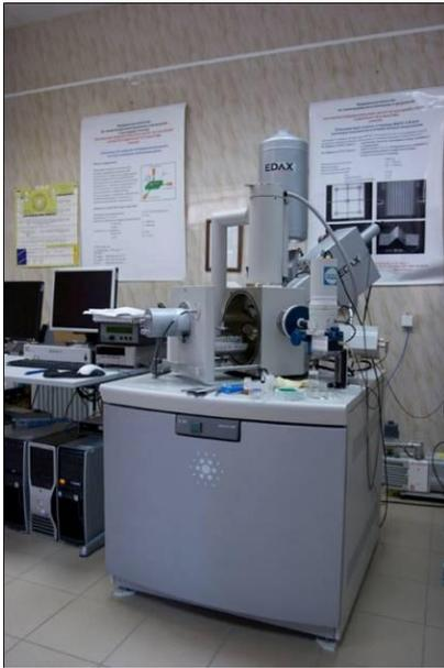
Рисунок 4.7 – Внешний вид РЭМ Quanta 200 (FEI)
