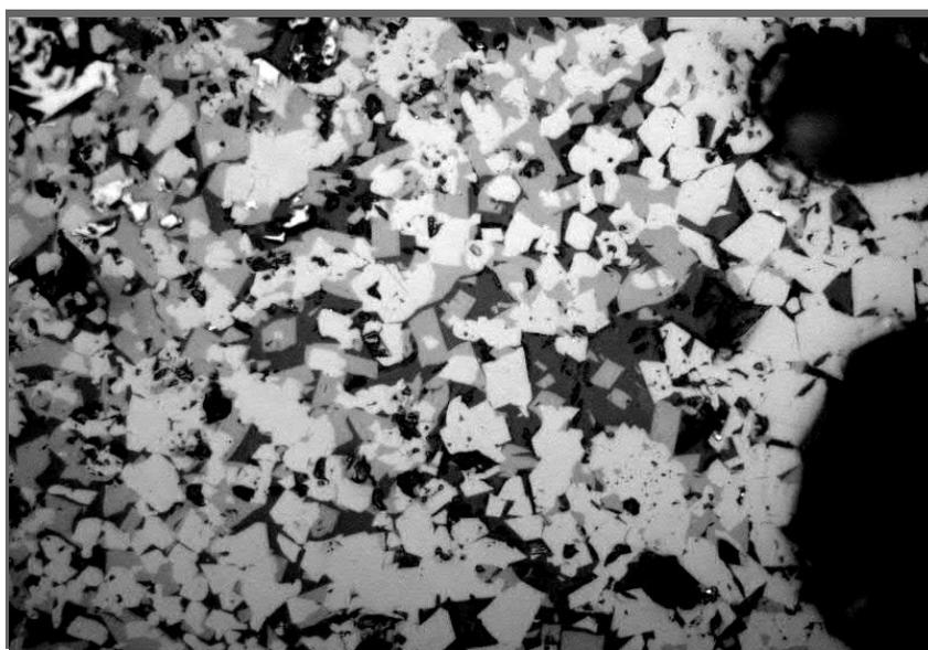
Рисунок 3.8 – Микроструктура агломерата с добавкой 3 % НКШ. Магнетит – белый, ферриты – светлосерые пластинчатые кристаллы, стеклофаза – темносерые. Отраженный свет, x500
