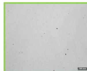
Рисунок 1 – Характерные дефекты, зафиксированные в структуре образцов из сплава ЭП741НП при проведении параметрических исследований процесса СЛС
