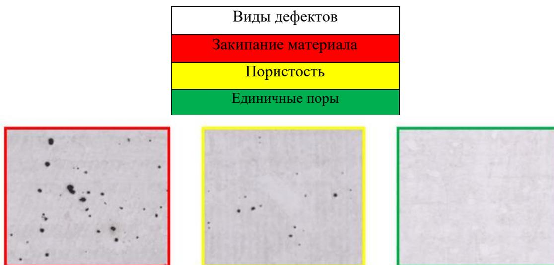
Рисунок 3 – Дефекты, зафиксированные в структуре образцов из сплава АЖК при проведении параметрических исследований процесса СЛС
