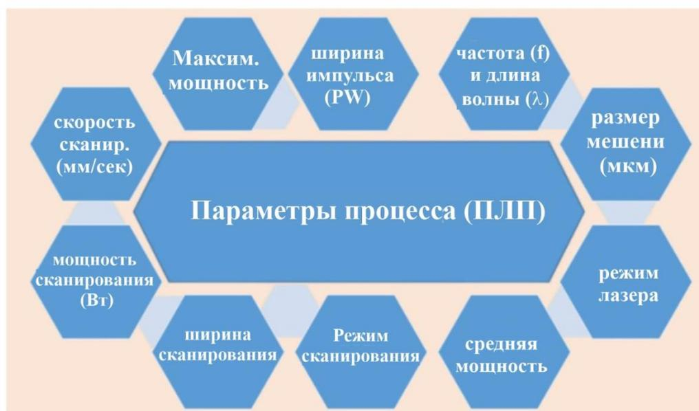
Рисунок 1.4. Схема, демонстрирующая наиболее важные параметры процесса СЛП [34].
