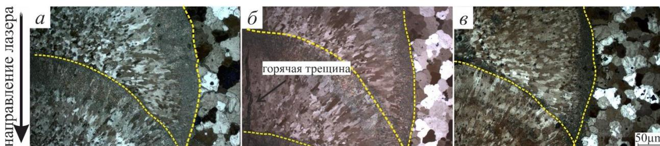
Рисунок. 4.9 Микроструктура (СМ) поперечного сечения ЗЛП гомогенизированных сплавов 7075-TiB с добавками Zr: (*а,а'*) 7075-TiB 0.1Zr, (*б, б'*) 7075-TiB 0.2Zr, и (*в, в'*) 7075-TiB 0.5Zr
