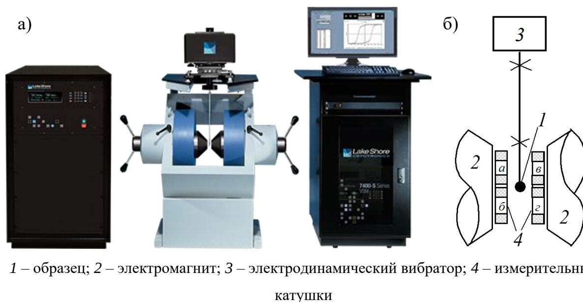
Рисунок 2.9 – Вибрационный магнитометр Lake Shore 7407. а) внешний вид установки [76]; б) принципиальная схема [77]
