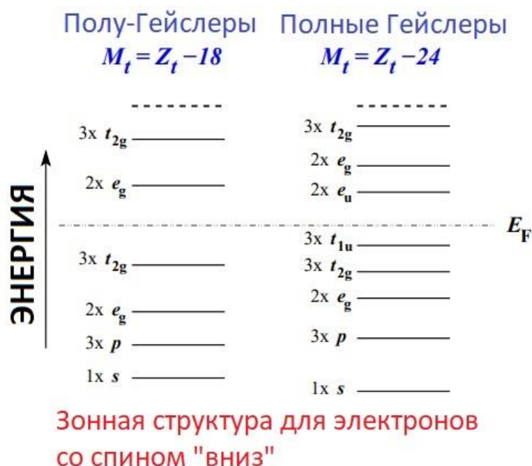
Рисунок 1.11 – Схематическое представление энергетических уровней электронов со спинов «вниз» в зонной структуре для сплавов полу-Гейслера и полных сплавов Гейслера.
