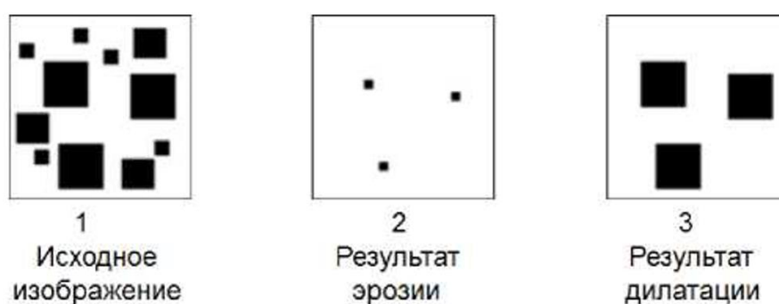
Рисунок 34 – Схема удаления шумов на основе процедуры «эрозия + дилатация»
