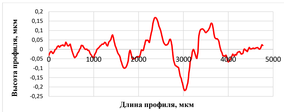
Рисунок 49 – Вычитание низкочастотной составляющей (наилучшим полиномом)
