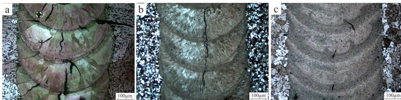
Рисунок 9. Микроструктура (световая микроскопия) ЗЛП гомогенизированных 500 °С, 6.5ч сплавов: (a)  $^{10}7075-2Si$ , (b)  $^{11}7075-ScZr-2Si$ , (c)  $^{12}7075-TiB-2Si$ .
