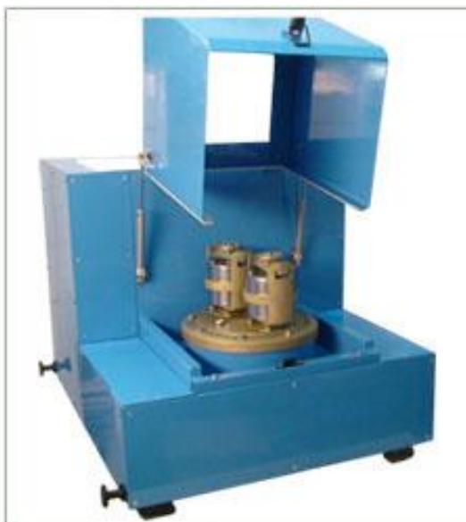
Рисунок 2.3. Фотография планетарной мельницы, используемой в настоящей работе, планетарная шаровая мельница «Активатор 2S».
