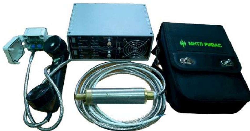
Рисунок 2.2 – Комплект регистратора искробезопасного портативного акустического сигнала РИПАС («МНТЛ-РИВАС»)
