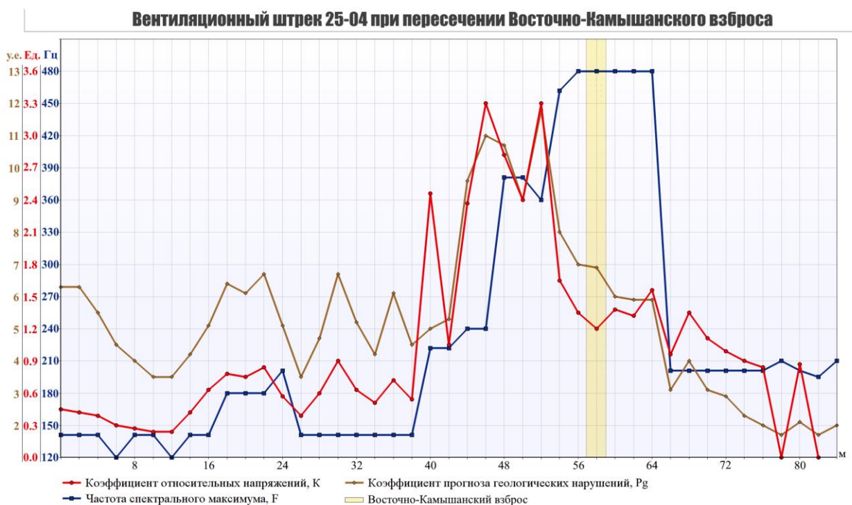
Рисунок 3.18 – Распределение параметров ИАС в вентиляционном штреке 25-04 при пересечении Восточно-Камышанского взброса: по вертикали – значения коэффициента относительных напряжений K (ед.), частоты спектрального максимума F (Гц) и коэффициента прогноза геологических нарушений P_g (у.е.); по горизонтали – расстояние от начального пикета в метрах
