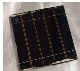
Рисунок 33 – Вид мини-модулей после процессов P2 и P3
