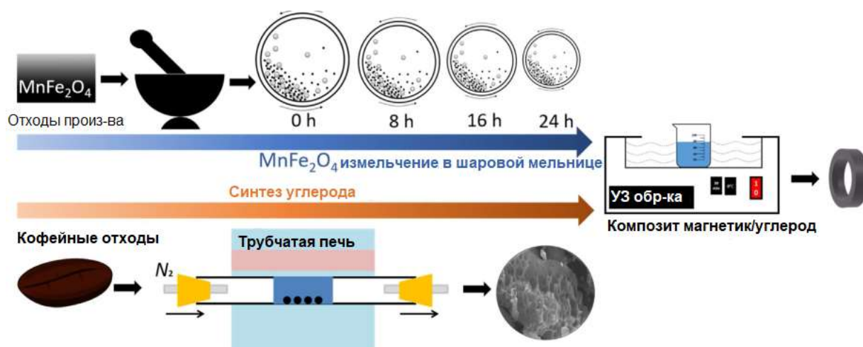
Рисунок 66 – Схема получения композиционного РПМ углерод/MnFe 2 O 4 [133]
