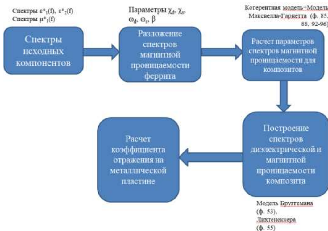
Рисунок 185 – Схема расчета коэффициента отражения на металлической пластине феррит-полимерных композитов
