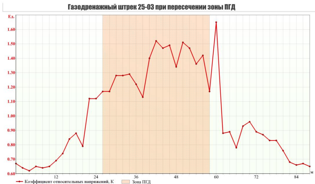
Рисунок 6 – Распределение относительных напряжений в газодренажном штреке 25-03 при пересечении зоны ПГД: по вертикали – значения коэффициента относительных напряжений K (ед.); по горизонтали – расстояние от начального пикета в метрах
