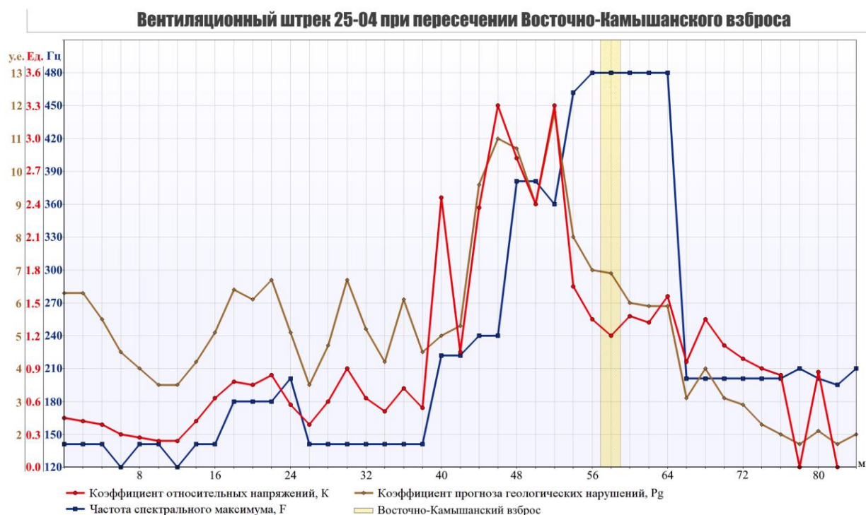
Рисунок 9 – Распределение параметров ИАС при пересечении Восточно-Камышанского взброса вентиляционным штреком 25-04: по вертикали – значения коэффициента относительных напряжений K (ед.), частоты спектрального максимума f (Гц) и коэффициента прогноза геологических нарушений P_g (у.е.); по горизонтали – расстояние от начального пикета в метрах
