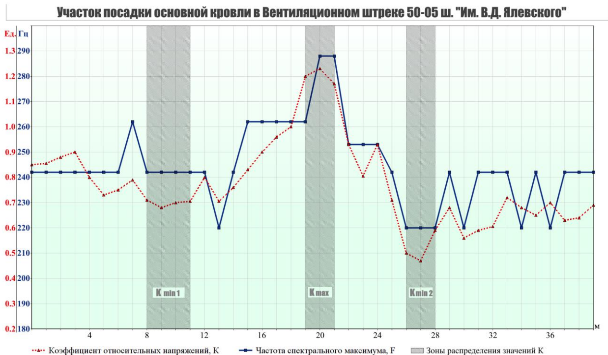
Рисунок 10–Распределение параметров ИАС в вентиляционном штреке 50–05 шахты «Им. В.Д. Ялевского» на участке посадки основной кровли: по вертикали – значения коэффициента относительных напряжений K (ед.) и частоты спектрального максимума f (Гц); по горизонтали – расстояние от начального пикета в метрах
