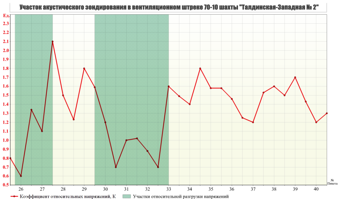
Рисунок 4 – Распределение относительных напряжений в вентиляционном штреке 70-10: по вертикали – значения коэффициента относительных напряжений K (ед.); по горизонтали – номера пикетов по профилю наблюдений
