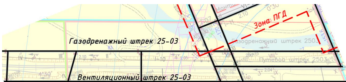
Рисунок 5 – План горных работ по угольному пласту «Поленовский» в зоне расположения газодренажного штрека 25-03
