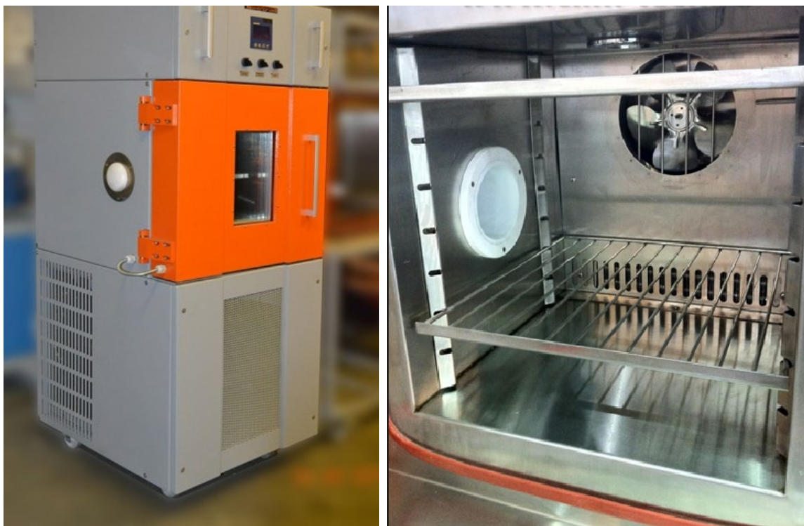
Рисунок 2.2.2 – Программируемая климатическая камера КТХВ-2.4.1
