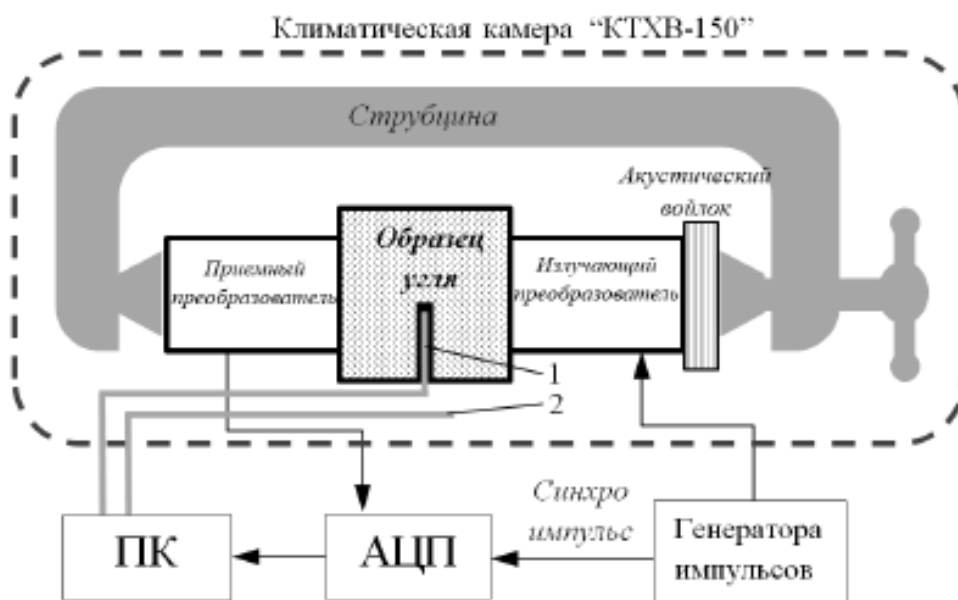
Рисунок 2.4.1 – Схема лабораторного стенда (1 – термопара для измерения температуры внутри образца, 2 – термопара для измерения температуры воздуха в камере)
