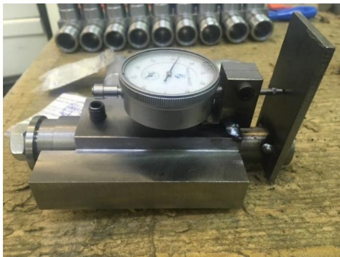
Рисунок 3.10 — Оправка для алмазного выглаживания, изготовленная в производственных условиях завода ООО «ПСК ПластМеталл»
