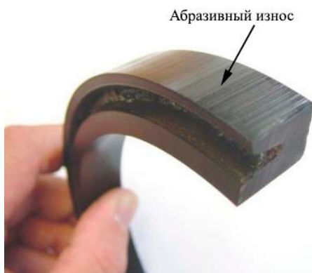
Рисунок 1.6 — П-образная манжета штока из материала марки NBR со следами износа
