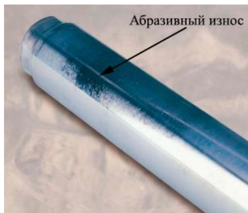
Рисунок 1.10 — Абразивный износ штока
