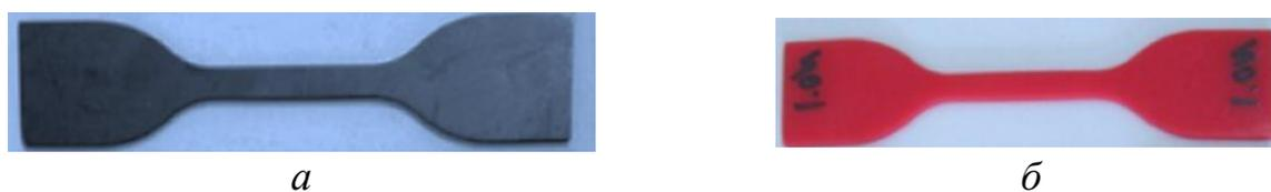
Рисунок 5 — Образцы материалов уплотнений для проведения испытаний на одноосное растяжение: а – *NBR*; б – *PTFE*
