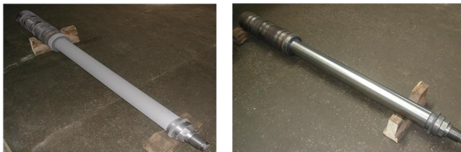
Рисунок 4.2 - Шток с твердосплавным покрытием до (а) и после (б) шлифования [5]
