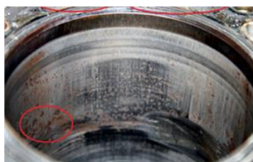
Следы локального износа (фреттинг-коррозии) на зеркале цилиндра
