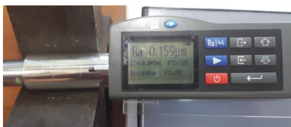
Рисунок 17 – Шероховатость поверхности покрытия после алмазного выглаживания, полученная при обработке с усилием деформирования 165-170 Н; радиус выглаживателя 3,0 мм.
