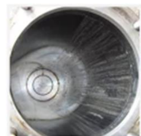
Следы абразивного износа на внутренней поверхности цилиндра
