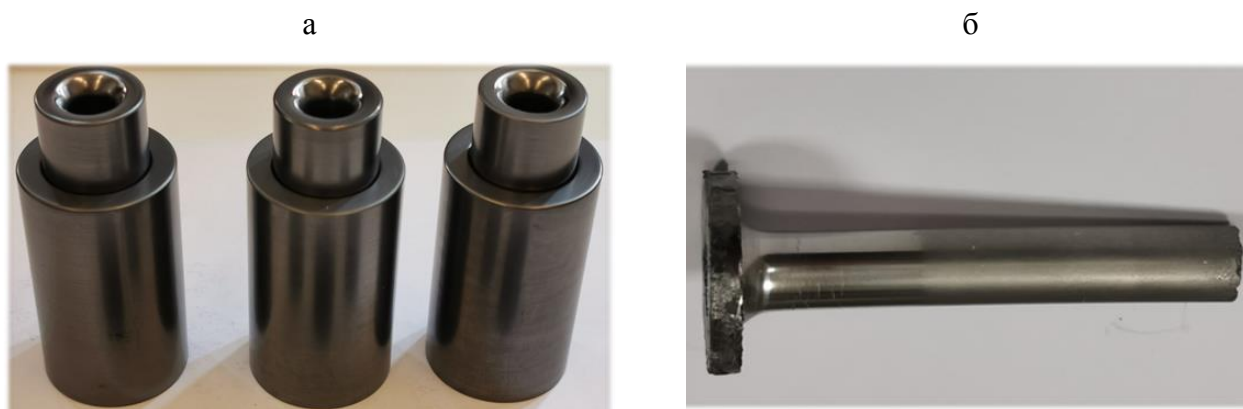
Рисунок 15 – Комплект оснастки для проведения процесса (а) и внешний вид слитка, полученный методом ИПЭ из исходного крупнозернистого порошка
