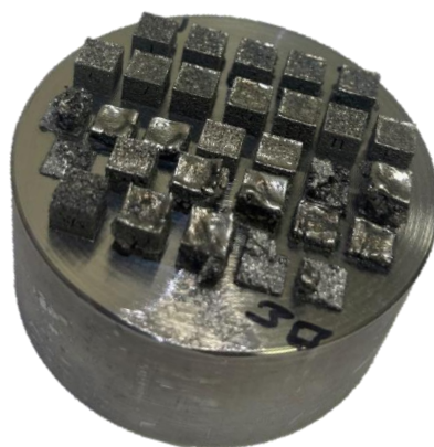
Рисунок 43 – Образцы из смеси Ti-50Al (ат. %) на подложке из ВТ6.
