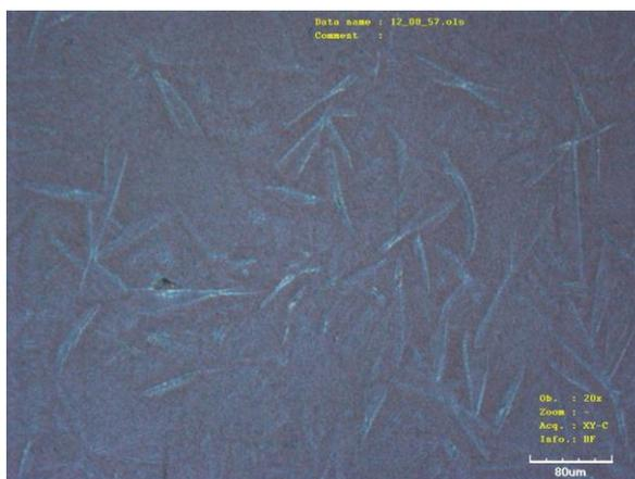
Рисунок 24 – Поверхность пленки дырочно-транспортного неорганического материала  $\text{NiO}_x$  на подложке с FTO (оптический микроскоп)
