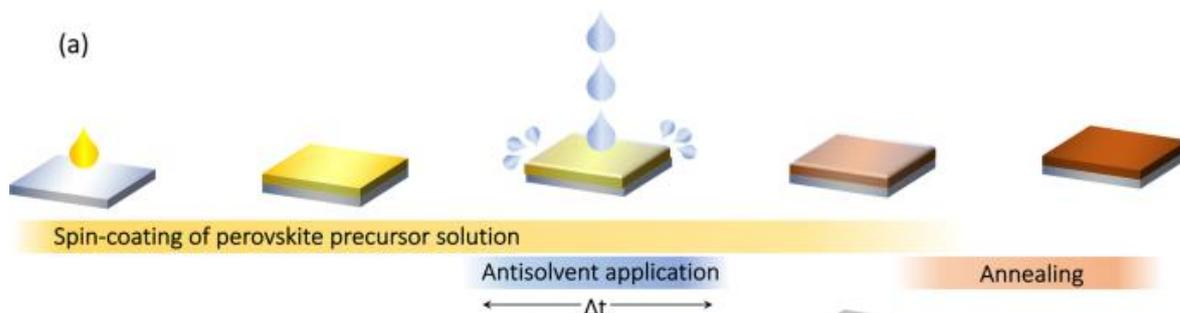
Рисунок 19 – Схематическое изображение процесса формирования пленки перовскита методом спин-коатинг [65]
