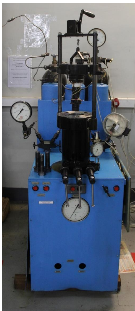
Рисунок 2.15 – Общий вид установки компрессионного сжатия (УКС)
