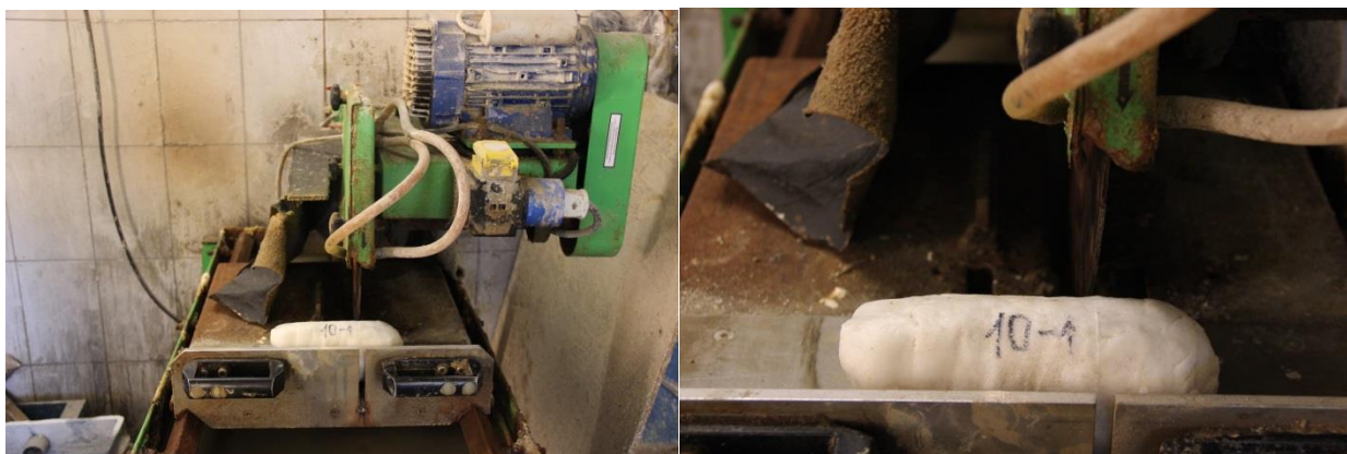
Рисунок 2.4 – Подготовка монолита 10-1 к отрезанию на камнерезном оборудовании
