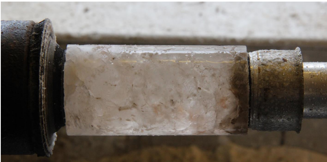
Рисунок 2.7 – Общий вид токарного станка с закрепленным в нем образцом бишофитовой породы
