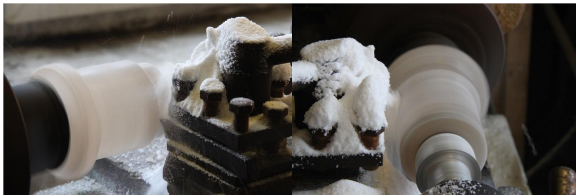
Рисунок 2.6 – Изготовление из заготовки, закрепленной в токарном станке, образца бишофитовой породы
