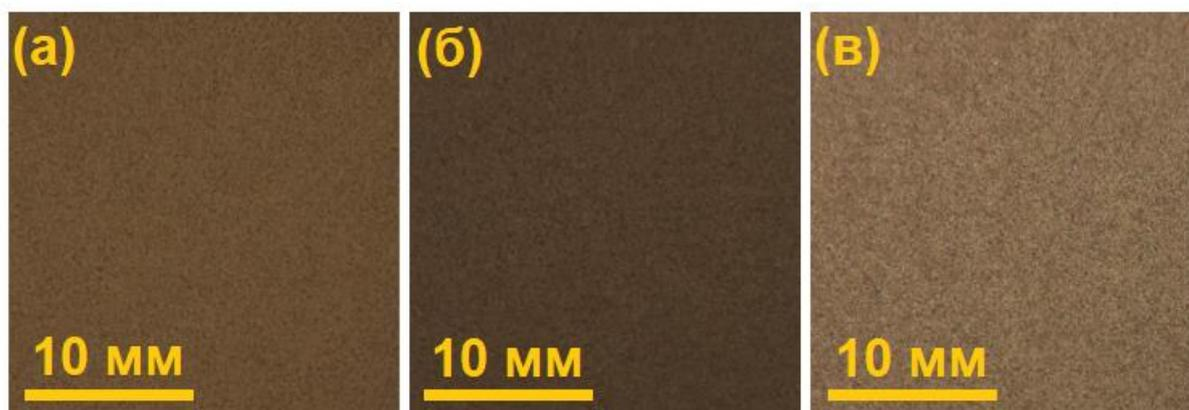
Рисунок 19 – Внешний вид покрытий, полученных методом ПЭО в водном растворе, содержащем 3 г/л NaOH, 5 г/л  $\text{Na}_2\text{O} \cdot 2,9\text{SiO}_2 \cdot 18\text{H}_2\text{O}$ , средняя толщина которых приблизительно: а) – 17; б) – 48; в) – 82 мкм
