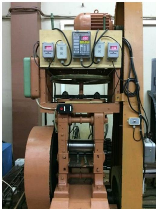
Рисунок 2.3 – Двухвалковый прокатный стан 150x235 с установленной микроконтроллерной системой измерения сил прокатки в лаборатории кафедры «ОМДиАТ»
