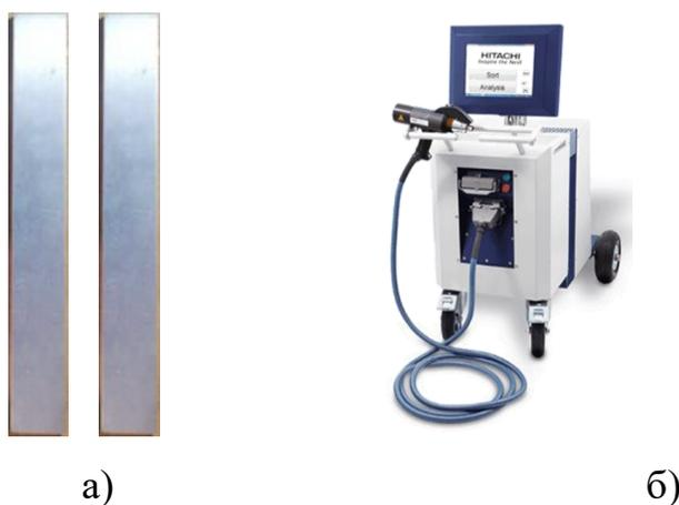
Рисунок 2.1 – Образец и установка для определения химического состава сплава:
