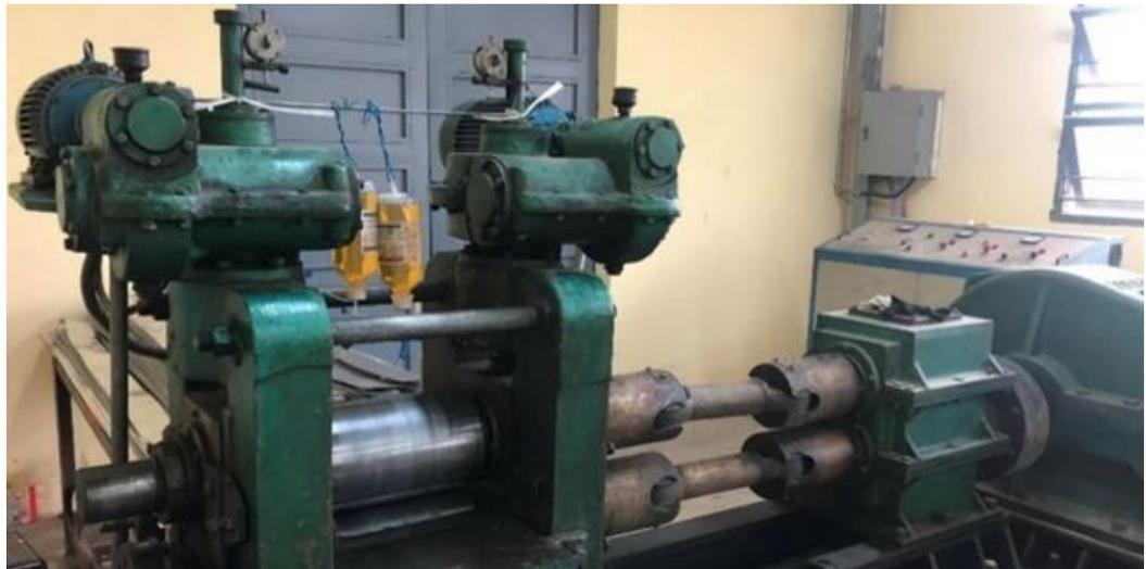
Рисунок 5. 1 - Промышленный двухвалковый стан 175x300
