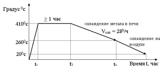
Рисунок 2.2 – Режим отжига опытных полос из алюминиевого сплава [105]
