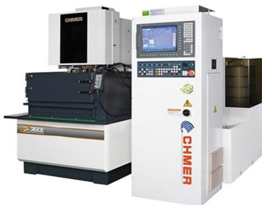
Рисунок 2.4 – Электроискровая отрезная стана ЧПУ CHMER GX360L
