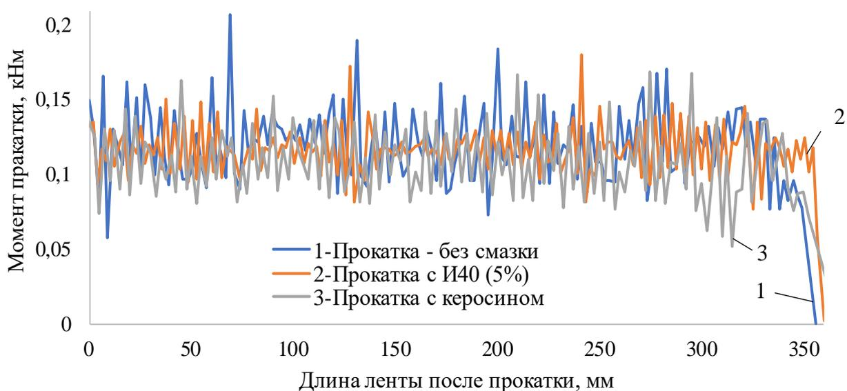
Рисунок 4.5 – Распределение момента по длине участка лент при моделировании прокатки с обжатием 20% из алюминиевого сплава АД33:
