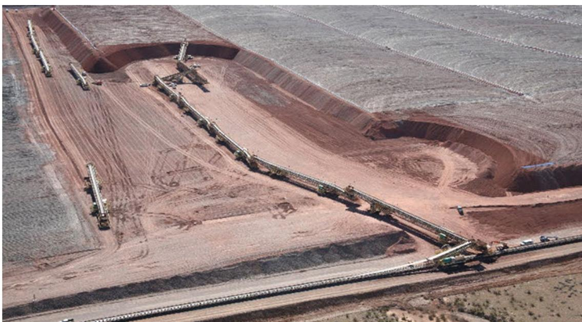
Рисунок 1.17 – Мобильная система конвейеров
