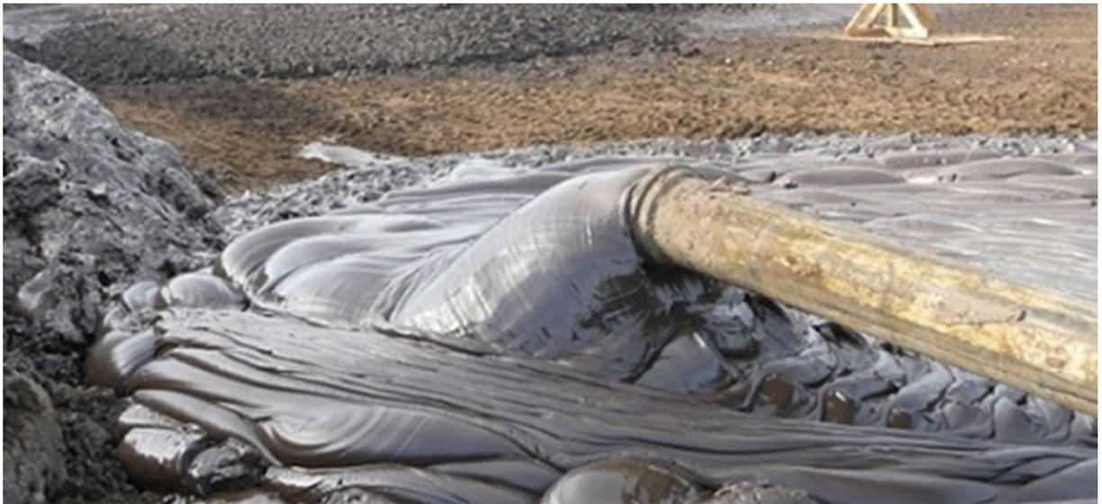
Рисунок 1.10 – Общий вид хвостовых пульп, сгущенных до состояния пасты
