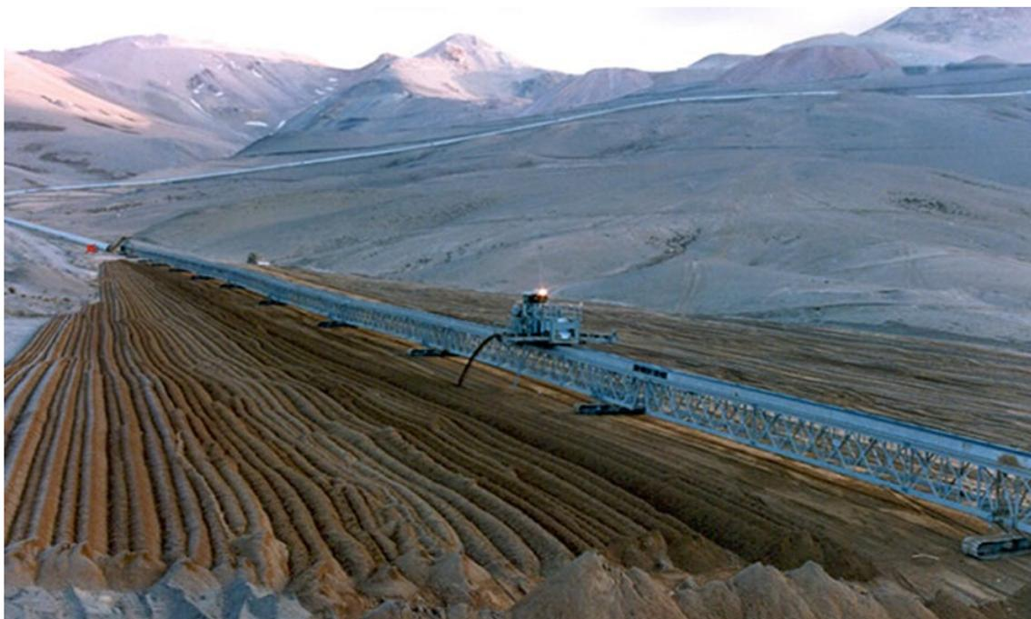
Рисунок 1.16 – Мобильный конвейер-стакер
