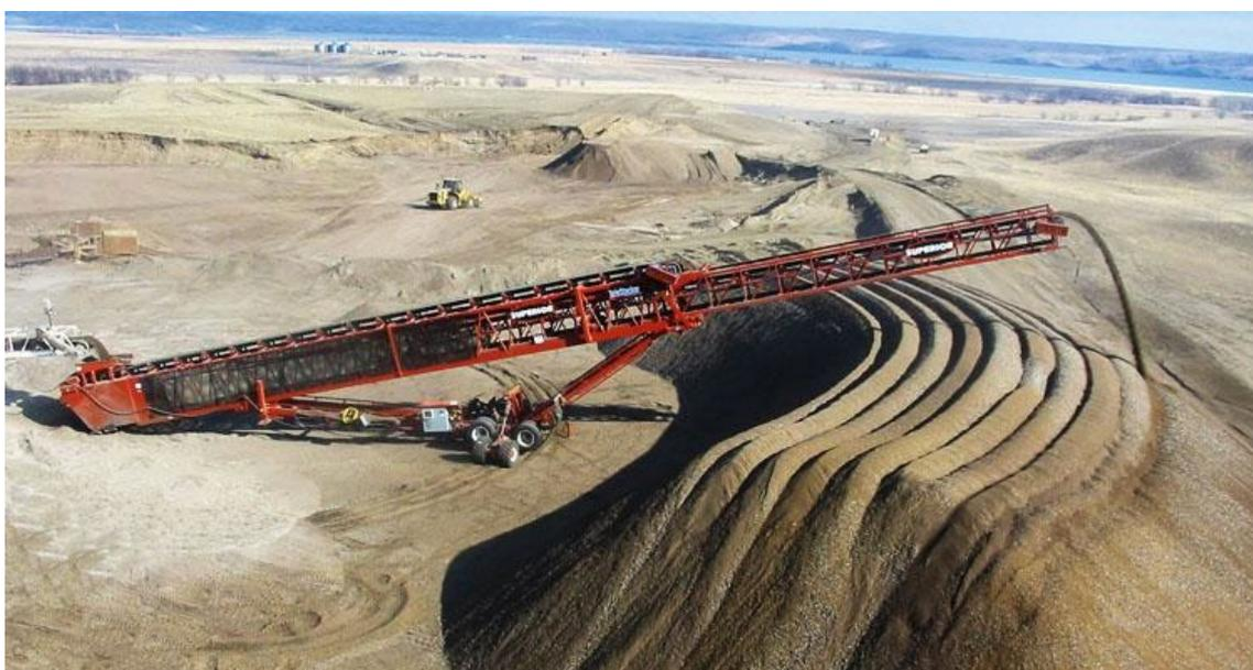
Рисунок 1.15 – Радиальный телескопический конвейер-стакер
