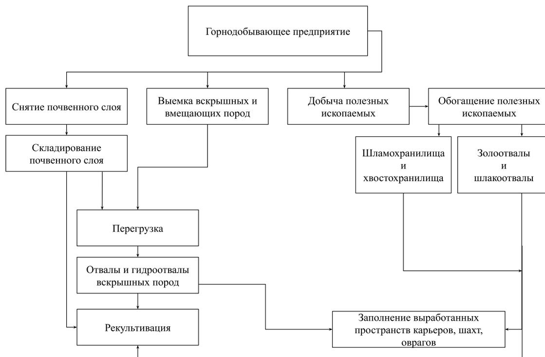
Рисунок 1.3 – Принципиальная схема формирования техногенных массивов на предприятиях горно-обогатительного комплекса
