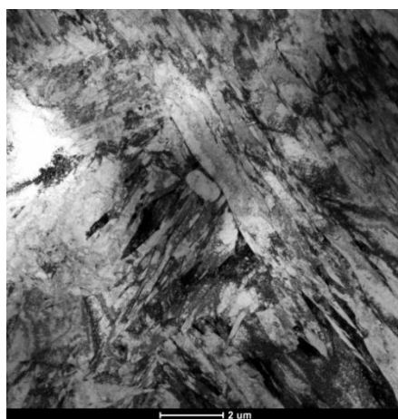
Рисунок 3.4 – Тонкая структура оболочечных труб Ø 6,9×0,4 мм из сталей ЭК181 и ЧС139 после скоростной закалки, ПЭМ
