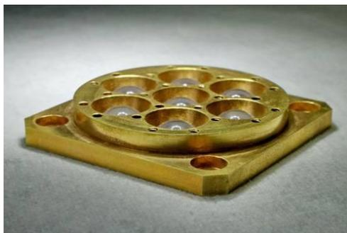
Рисунок 2.15 – Фотография матричного блока с 7 линзами
