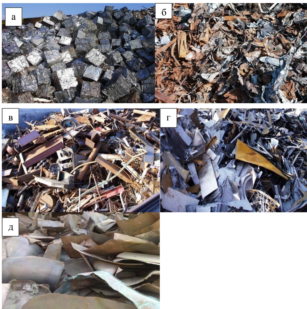
Рисунок 2.3 - Типы металлолома, используемые в ДСП-220 компании EZZ Flat Steel, Египет.
