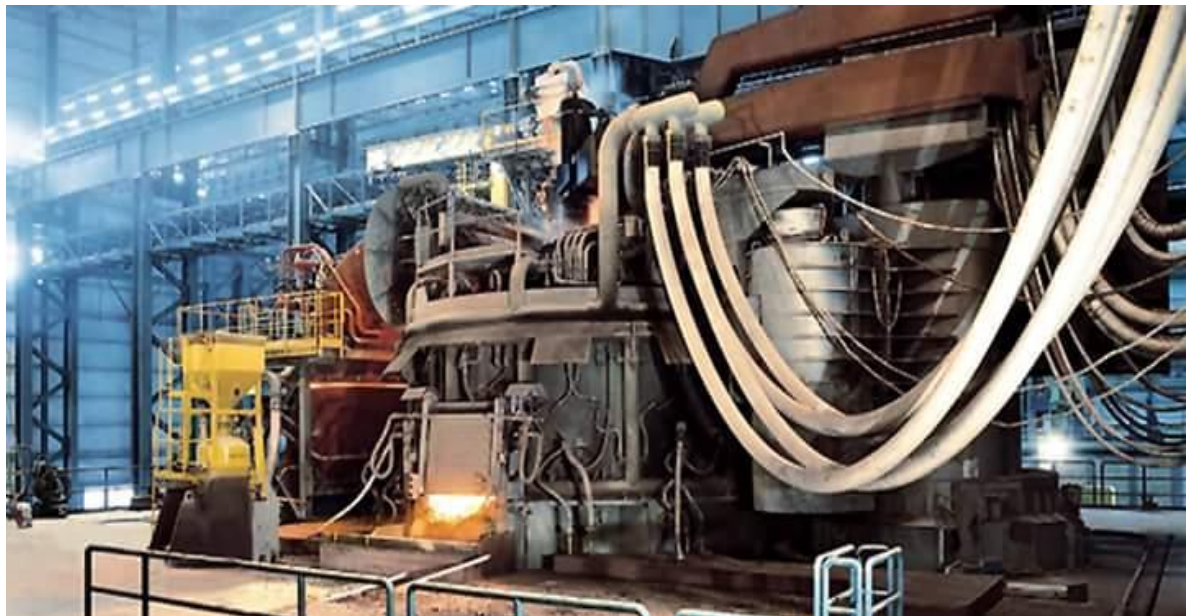
Рисунок 2.2 - Дуговая сталеплавильная печь ДСП-220 (EZZ FLAT STEEL), Египет
