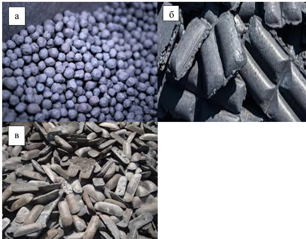
Рисунок 2.4 – Металлизированные окатыши (а), горячебрикетированное железо (б) и чугун (в), загружаемые в ДСП - 220, компания EZZ Flat Steel, Египет
