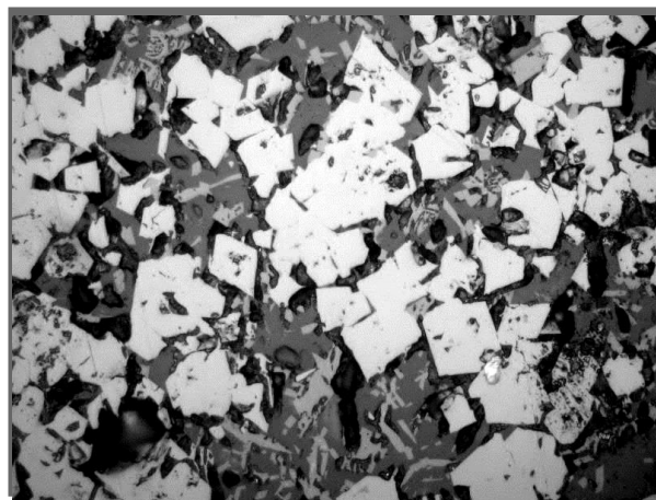
Рисунок 5 – Микроструктура агломерата с добавкой 1 % НКШ. Магнетит – белый, стеклофаза – серая, игольчатые кристаллы феррита – светло-серые. Отраженный свет, х500
