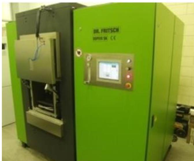
Рисунок 2.6 – Внешний вид прессы для горячего прессования DSP-515 SA
