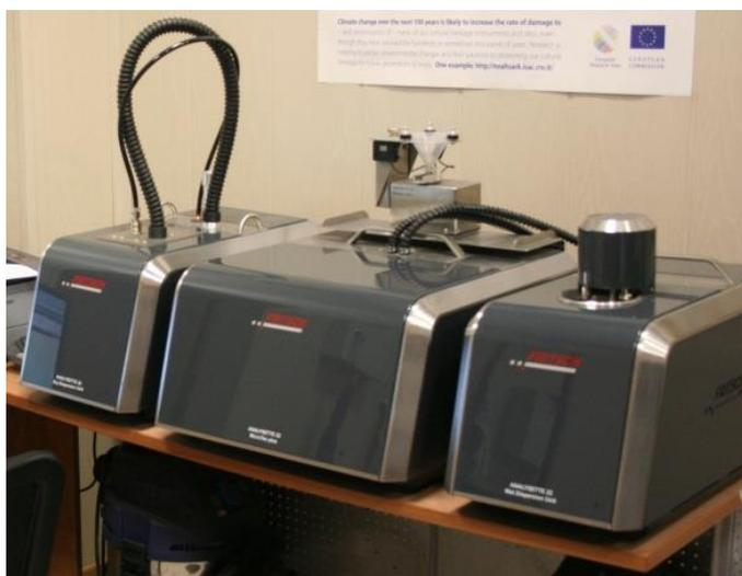
Рисунок 2.5 – Внешний вид лазерного анализатора ANALYSETTE 22 MicroTec plus
