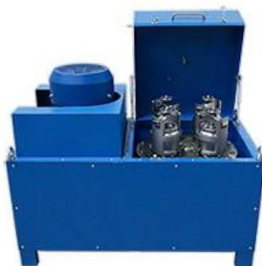
Рисунок 2.3 – Внешний вид ПЦМ Активатор-4М
