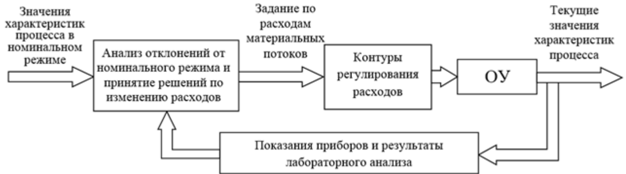
Рисунок 1.6 - Схема управления ТП экстракции фосфорной кислоты
