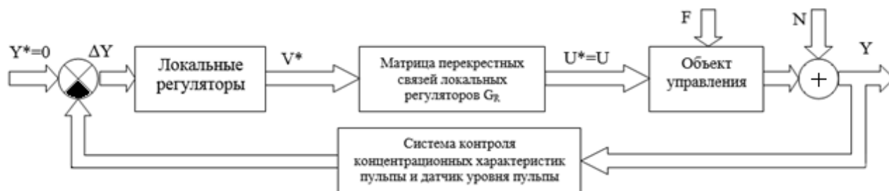
Рисунок 3.1 - Структурная схема многосвязной системы контроля и управления технологическими параметрами процесса экстракции
