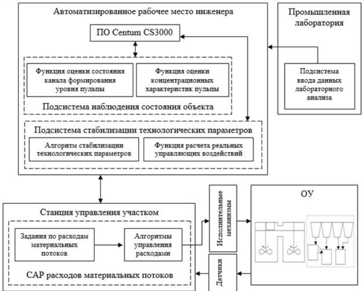
Рисунок 4.1 - Структурная схема многосвязной системы контроля и управления в составе существующей трехуровневой распределенной АСУ ТП
