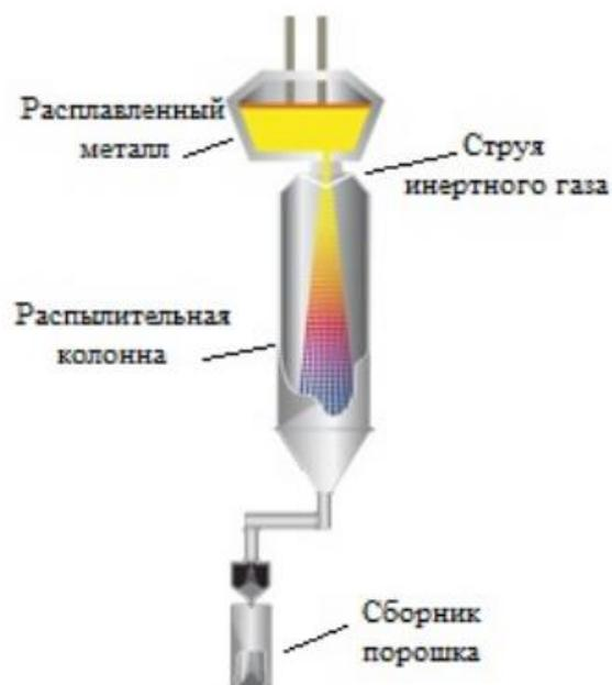
Рисунок 2 – Схема установки IGA
