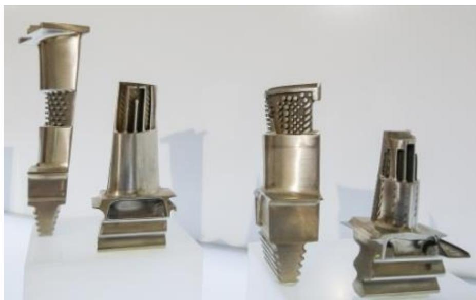
Рисунок 18 – Лопатки турбин высокого давления
