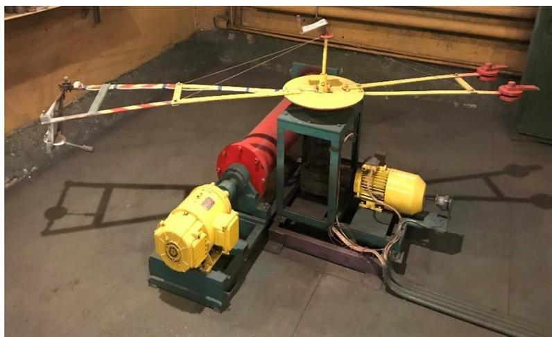
Рисунок 28 – Внешний вид центробежной СВС-установки для синтеза СВС-литых сплавов
