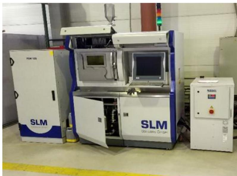
Рисунок 34 – Внешний вид установки SLM 280HL
