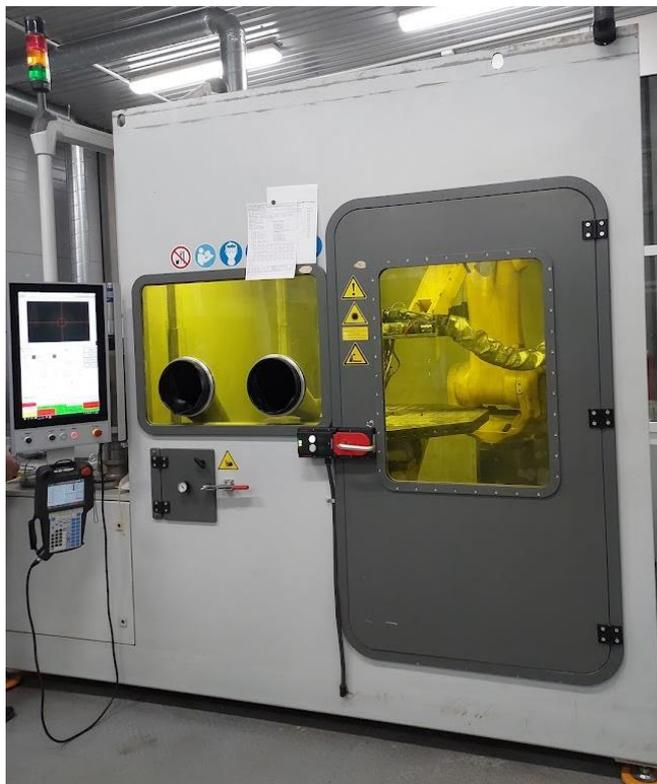
Рисунок 27 – Внешний вид установки прямого лазерного выращивания «ИЛИСТ-L»
