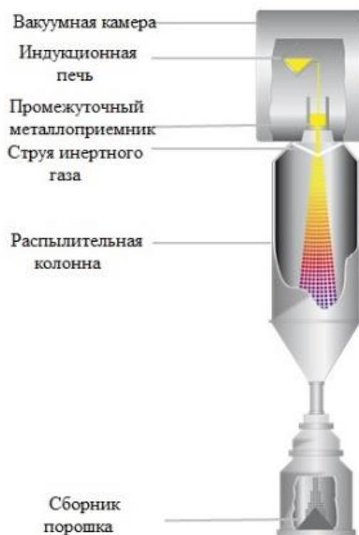
Рисунок 3 – Схема установка VIGA
