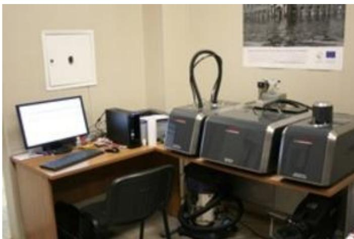
Рисунок 35– Внешний вид лазерного дифракционного анализатора размера частиц «ANALYSETTE 22 MicroTec plus»
