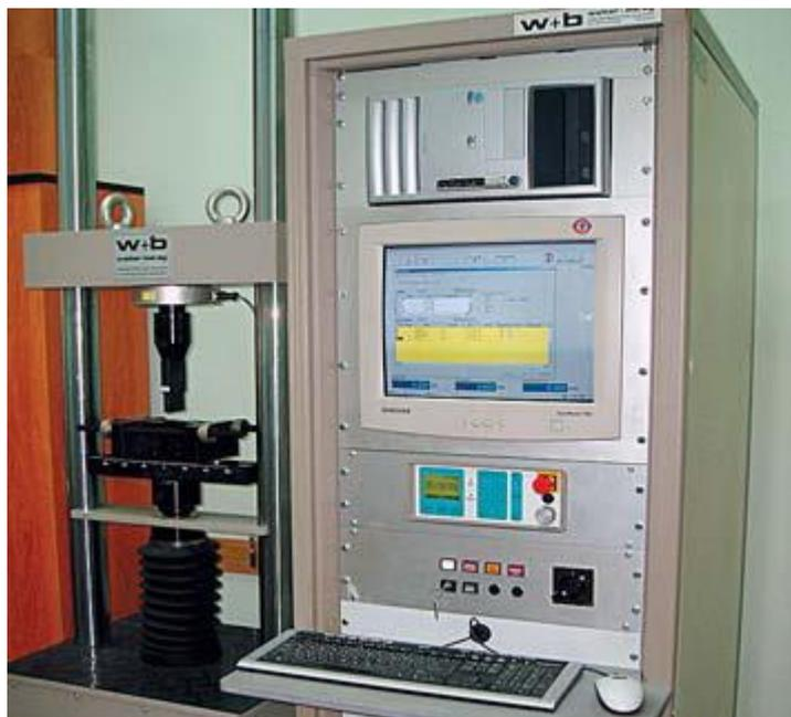
Рисунок 37 – Внешний вид универсальной машины для механических испытаний LF-100KN
