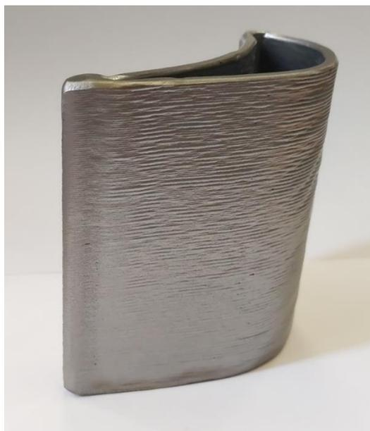
Рисунок 63 – Модельный образец турбинной лопатки 5-й ступени, построенный методом ПЛВ из овализованного порошка ВЖ159
