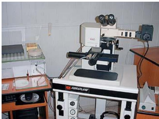
Рисунок 36 – Внешний вид нанотвердометра Nano-Hardness Tester
