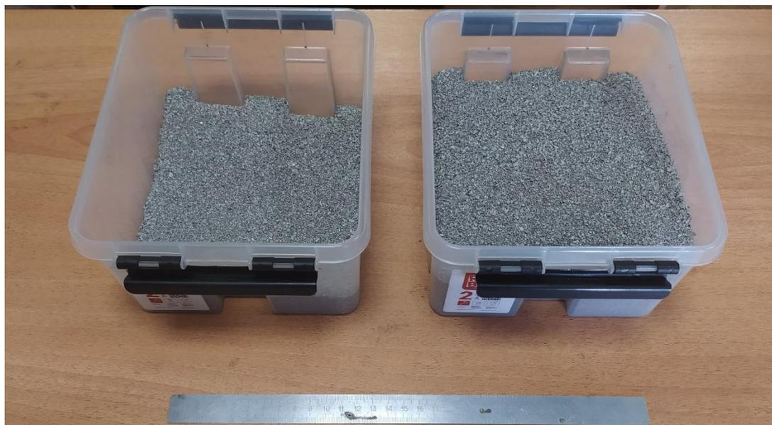
Рисунок 31 – Внешний вид размолотых на щековой дробилке слитков
