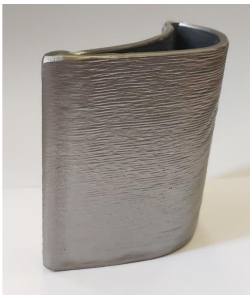
Рисунок 7 – Модельный образец турбинной лопатки 5-й ступени, полученный по технологии ПЛВ из овализованного порошка ВЖ159
