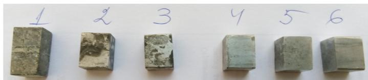
Рис.17 – Общий вид образцов после испытаний на коррозионную стойкость: 1 – Al-4Ca-2Ce-2Ni, 2 – Al-3,5Ca-3Mg-10Zn, 3 – Al-3,5Ca-3Mg-10Zn-0,4Zr, 4 – Al-2Ca-8Ce, 5 – Al-6,5Ca-3,5Ce, 6 – Al-5Ca-3Ce
