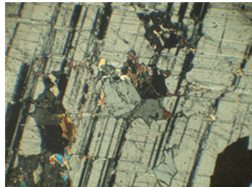
Рисунок 3.20 – Тройник \beta_1 - тридимита внутри корунда. С анализатором. Ув. 30×
