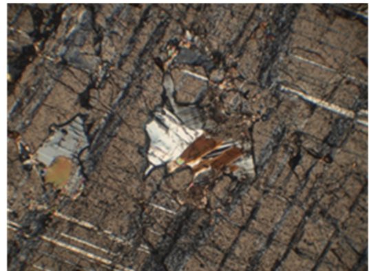
Рисунок 3.22 – Включения микроклина и пластинок биотита в корунде. С анализатором
