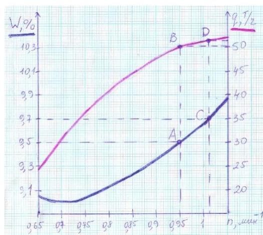
Рисунок 2. Зависимости удельной производительности фильтра ( q ) и влажности осадка ( W ) от частоты вращения дисков ( n )
