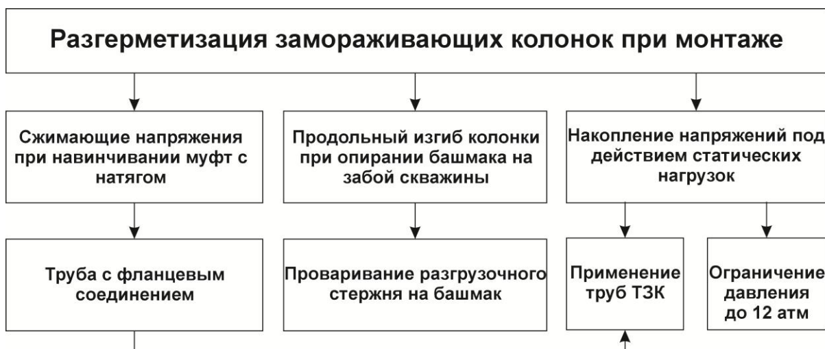
Рис.1.12.Схема причин разгерметизации замораживающей колонки при монтаже и методы предотвращения аварий.
