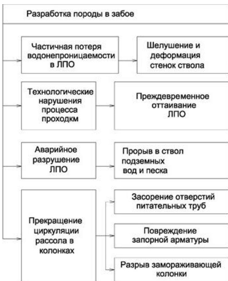
Рис. 1.13. Виды возникающих аварийных ситуаций в процессе проходки ствола под защитой ледопородного ограждения.
