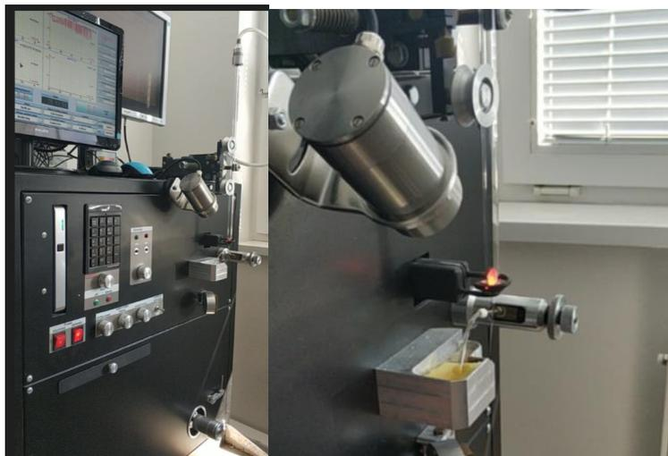
Рисунок 1.2 – Внешний вид установки для изготовления микропроводов в стеклянной оболочке по методу Тейлора-Улитовского
