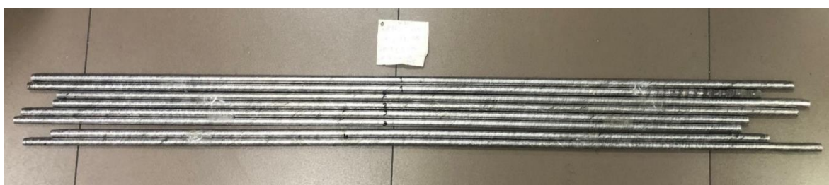
Рисунок 6 – Полученные на мини-станах РСП прутки диаметром 10 мм
