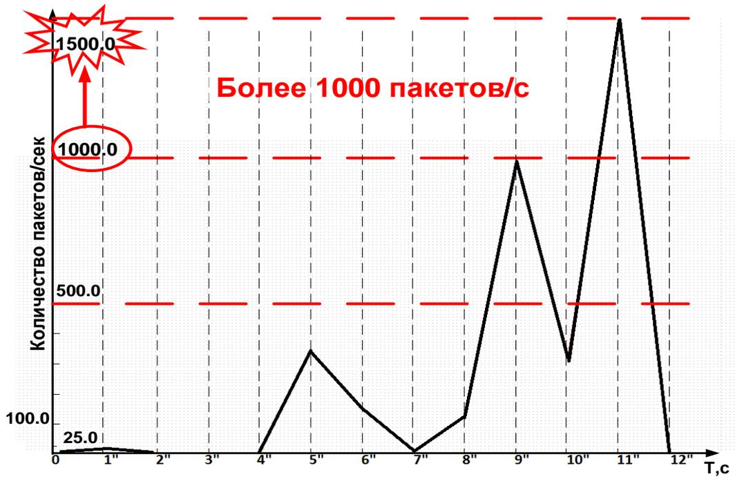
Рисунок 18 - Скорость потока данных при аномальной сетевой нагрузке
