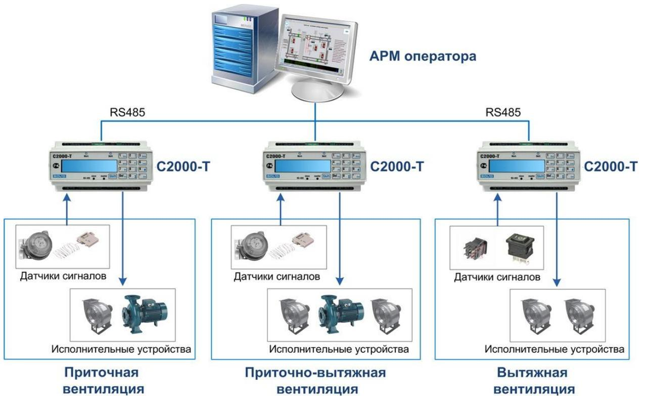
Рисунок А.2 – Пример структуры технологической сети
