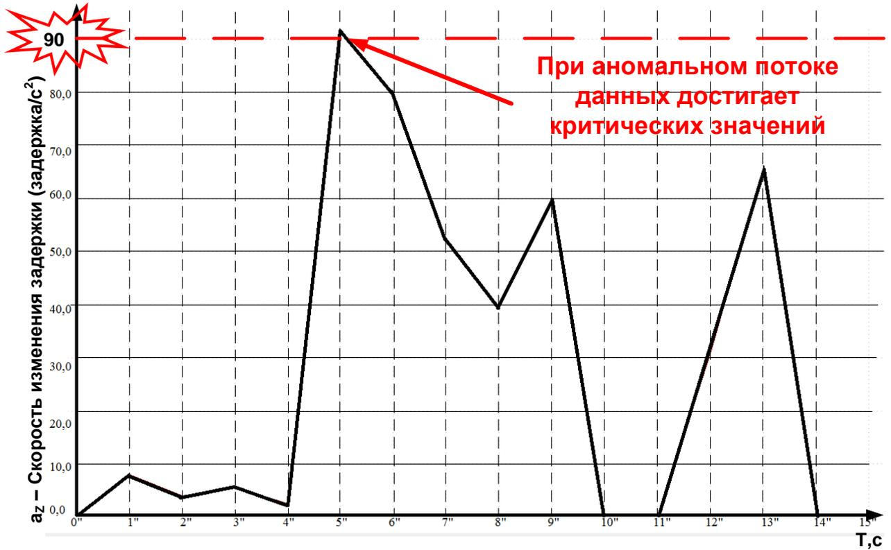
Рисунок 36 – Скорость изменения задержки пакетов при аномальной сетевой нагрузке
