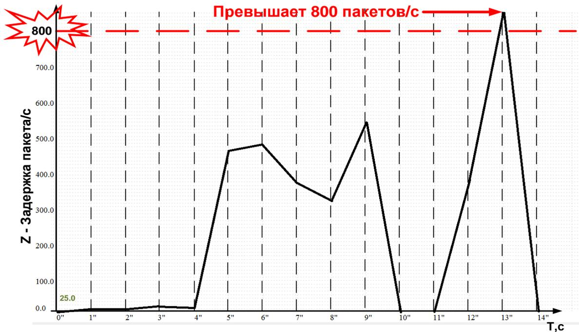
Рисунок 33 - Задержка пакетов при аномальной сетевой нагрузке
