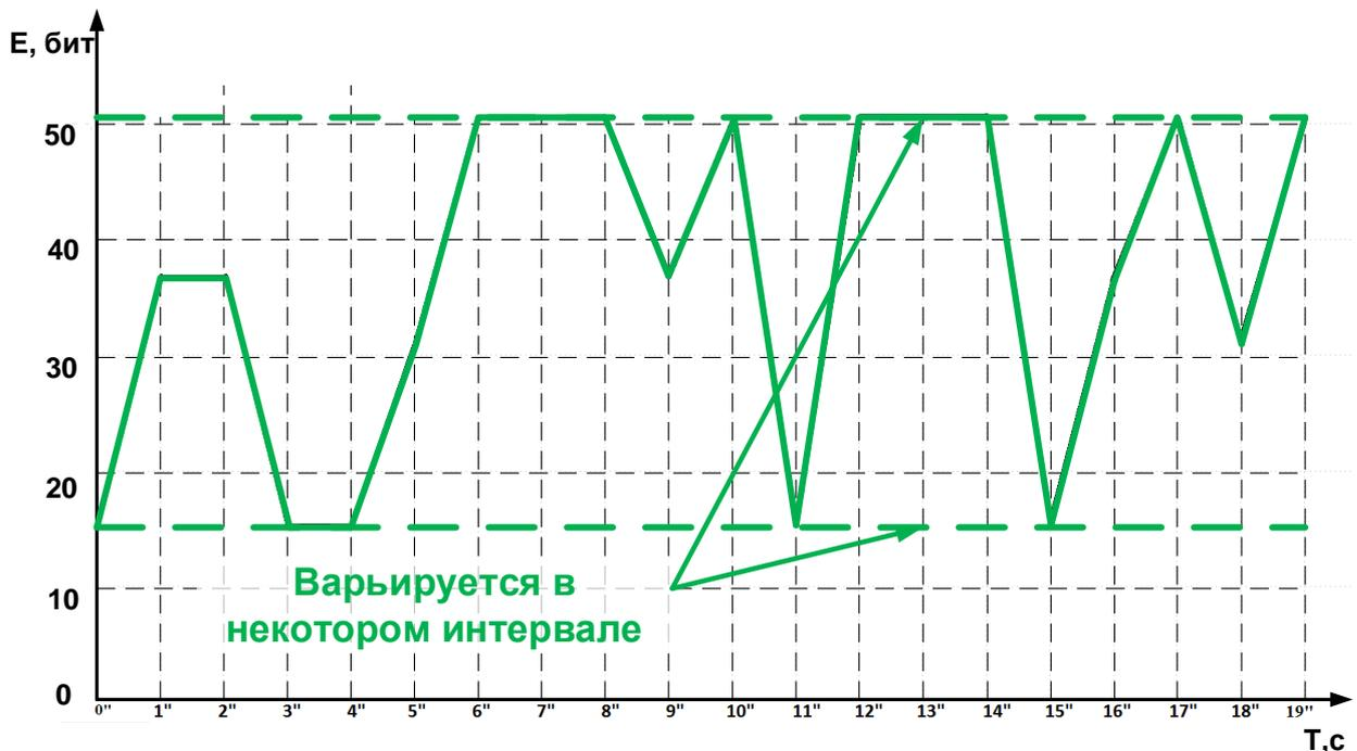
Рисунок 26 - Энтропия потока данных при нормальной сетевой нагрузке
