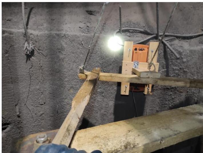
Рисунок 3.4.2.2 – Процесс перемещения антенного блока по поверхности крепи ствола
