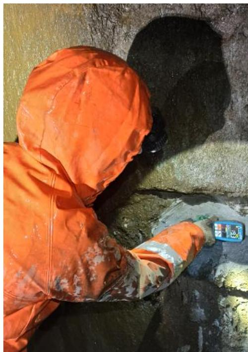
Рисунок 3.3.3.1 – Процесс определения прочности бетона ультразвуковым тестером UK1401
