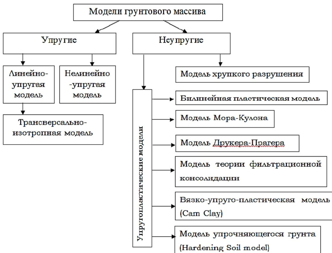
Рисунок 1.3.1 – Классификация моделей горных пород, применяющихся в геомеханических расчетах МКЭ
