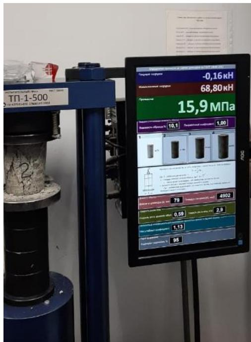
Рисунок 3.3.2.2 – Процесс испытания образцов бетона в строительной лаборатории
