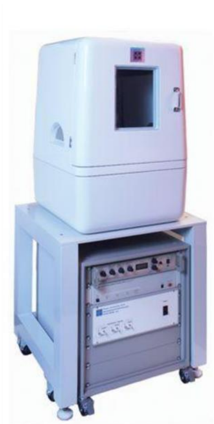
Рисунок 2.5 - Нанотрибоиндентор Nysitron TI 750 UBI
