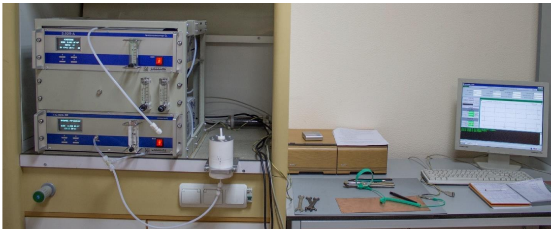
Рисунок 2.15 – Установка для исследования активности углей по отношению к озону
