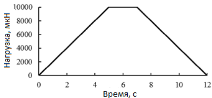
Рисунок 2.6 – Пример протокола нагружения при квази-статическом инструментальном индентировании
