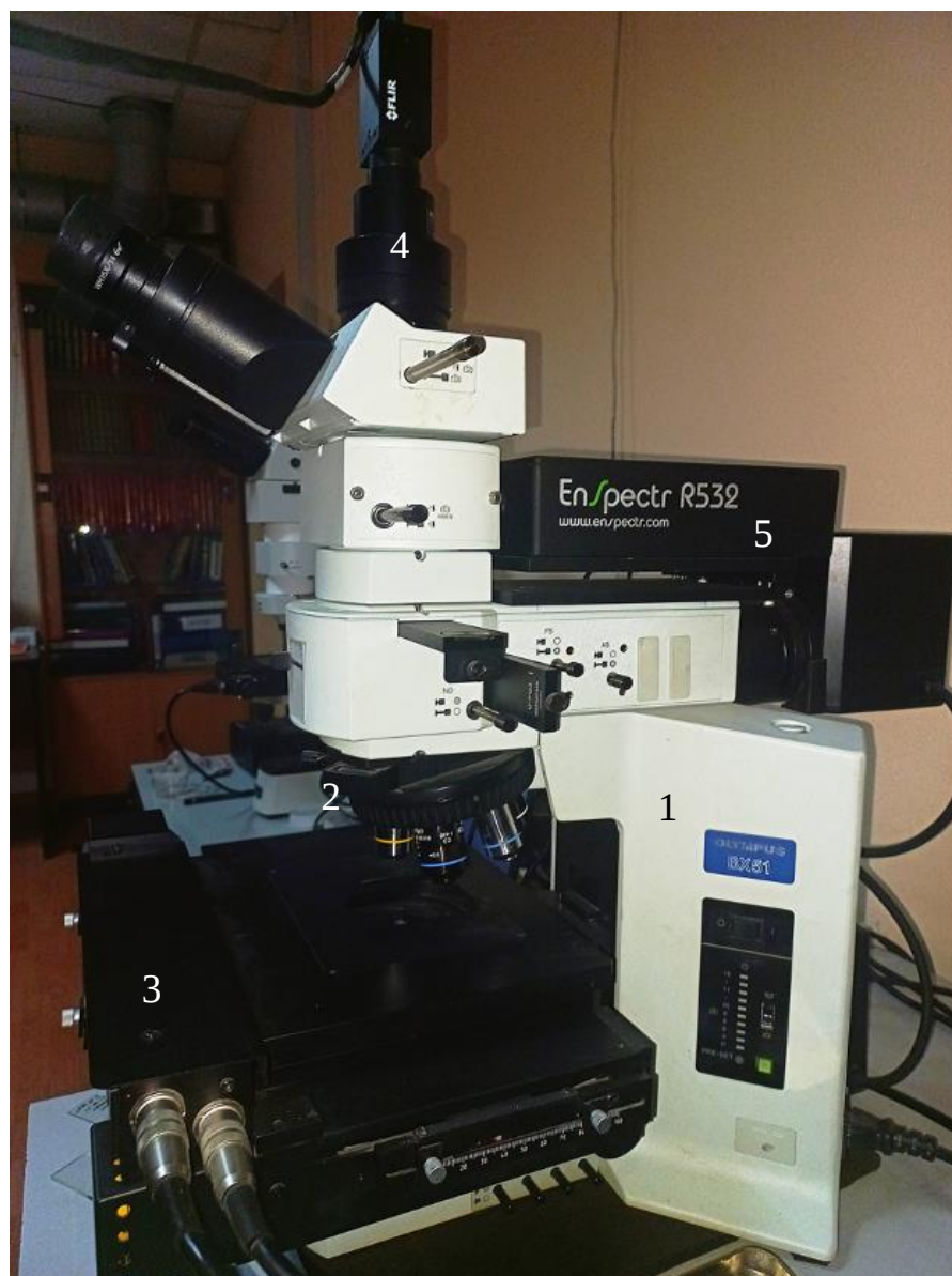
Рисунок 2.13 – Рамановский спектрометр на базе оптического микроскопа: состоит из состоящей из микроскопа отраженного света OLYMPUS BX51 (1), укомплектованного набором объективов (2), поляризатором, анализатором, автоматическим столиком (3), цифровой камерой (4) и Рамановским спектрометром EnSpectr R532 (5)
