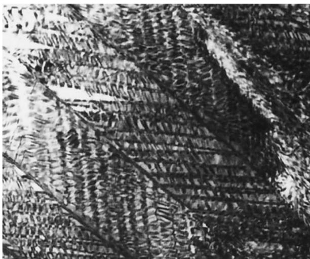
Рисунок 1.4 – Светлопольное изображение доменов образца  $ZrO_2$  3,0 мол.%  $Y_2O_3$
