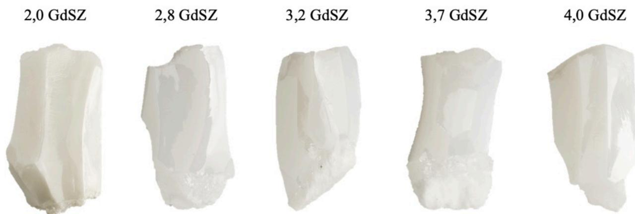
Рисунок 3.1 – Внешний вид кристаллов  $(\text{ZrO}_2)_{1-x}(\text{Gd}_2\text{O}_3)_x$
