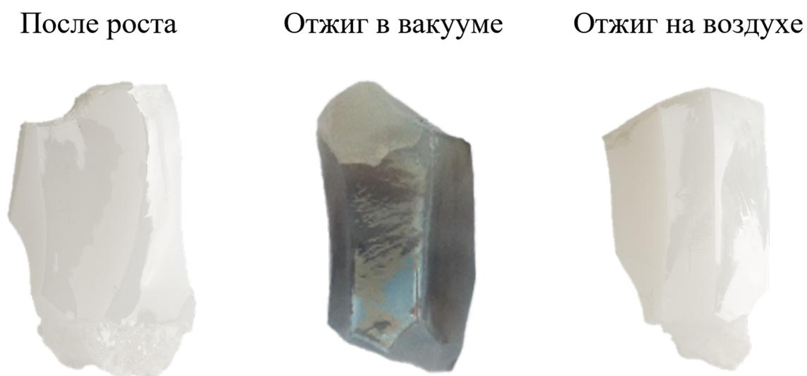
Рисунок 4.1 – Изображение кристаллов 4,0GdSZ до и после термообработки
