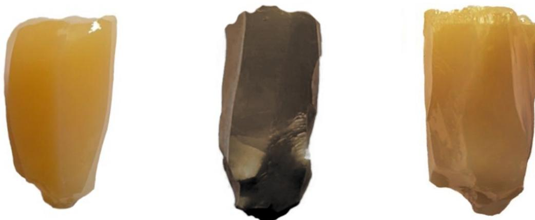
Рисунок 6.1 – Изображение кристаллов 3,7SmSZ до и после термообработки
