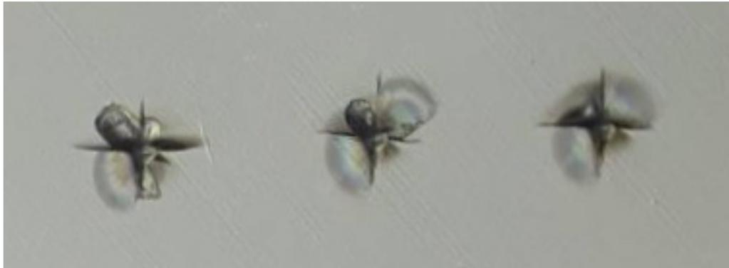
Рисунок 3.13 – Изображения поверхности образца кристалла 15GdSZ с отпечатками индентора
