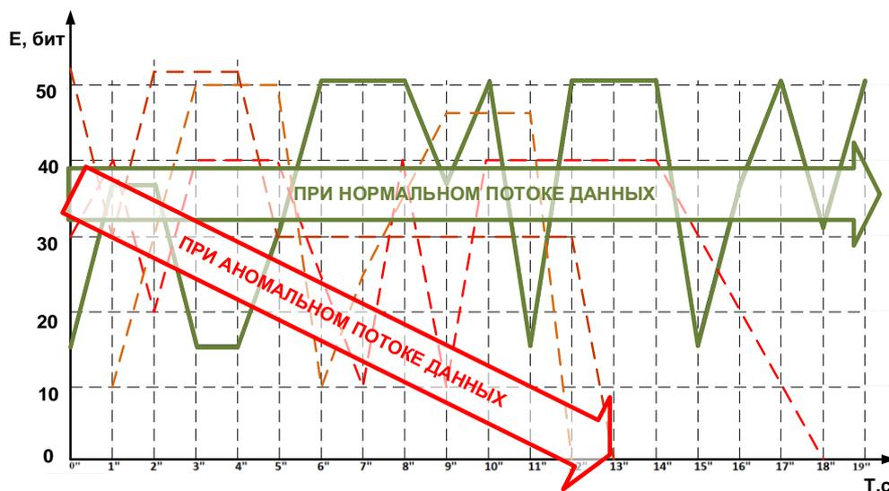
Рисунок 3 – Результаты имитационного моделирования энтропии нормального и аномального потоков данных
