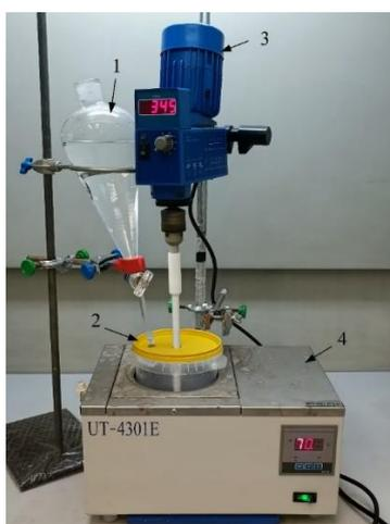
**Рисунок 2.1.** Схема установки для смешивания растворов при использовании водяной бани: 1 – дозатор подачи исходных растворов, 2 – реактор из полипропилена, 3 – верхнеприводная мешалка, 4 – водяная баня.
