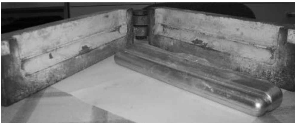
Рисунок 2.1 - Изложница для получения слитков с рабочим диаметром 20 мм
