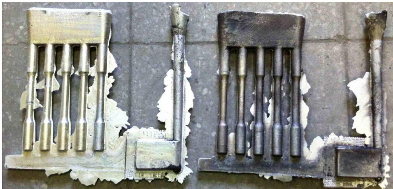
Рисунок 15 - Образцы для испытания механических свойств по ГОСТ 2856-79 из сплава типа МЛ5+0,2% Са (слева) и МЛ5 (справа) с литниковой системой, спроектированной на кафедре ТЛП
