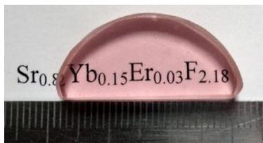
**Рис. 6.** Образец оптической керамики состава  $Sr_{0.812}Yb_{0.161}Er_{0.027}F_{2.188}$ .
