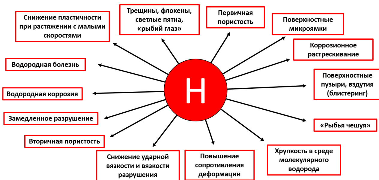
Рисунок 1.3 – «Водородные» дефекты в стали [9, 10, 11, 15, 16]
