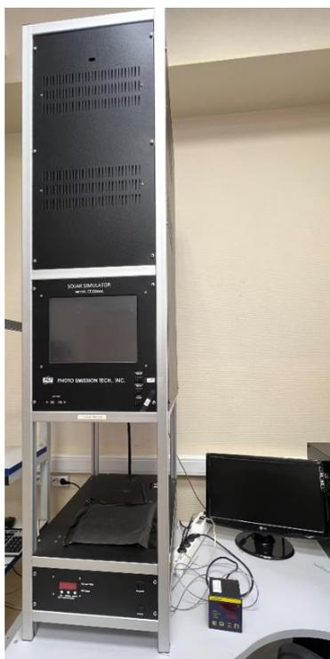
Рисунок 58 – Внешний вид имитатора постоянного солнечного излучения для инжекционного отжига облученных ФЭП
