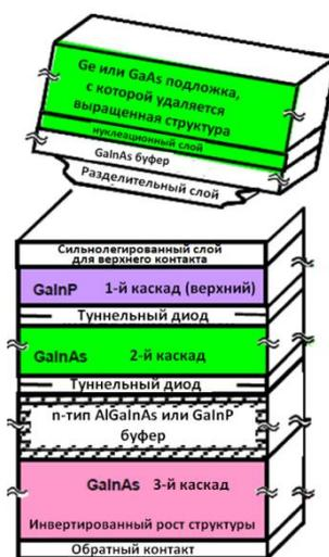
Рисунок 9 – Схематическое изображение концепции ИМР многокаскадных ФЭП на основе полупроводниковых материалов *АІІІВV* [66]
