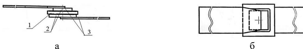
Рисунок 55 – Развязывающий диод БС КА [112]: а – вид в разрезе (1 – кристалл диода; 2 – компенсаторы; 3 – коммутирующие шины); б – вид с тыла
