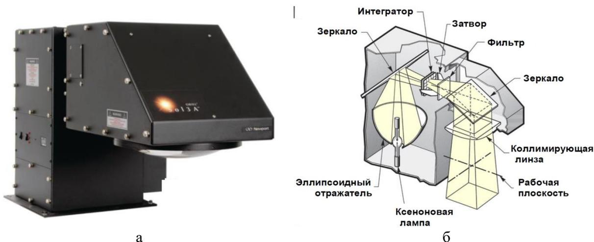
Рисунок 60 – Имитатор постоянного солнечного излучения для измерения ВАХ ЭС: а – внешний вид; б – основные элементы имитатора
